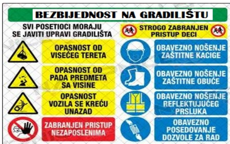
Slika 1. Znac i upozorenja, obavještenja i zabrane koji se moraju postaviti na ulazu u gradilište
